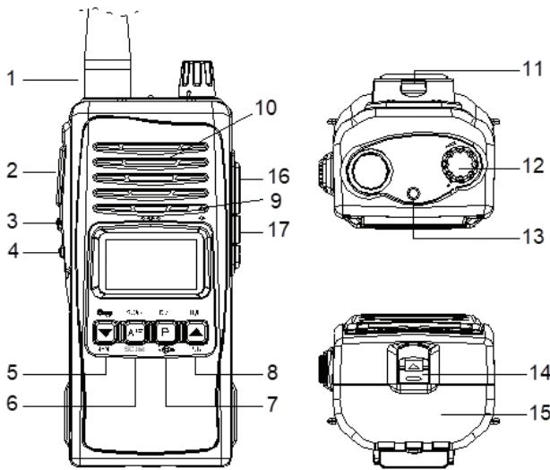
1. TNC-Anschluss für Antenne
